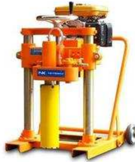
アスファルト舗装のコア採取
