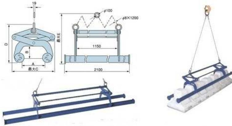
関知ブロックを7個までまとめて吊り上げますので、運搬・積込み・積降しに最適
